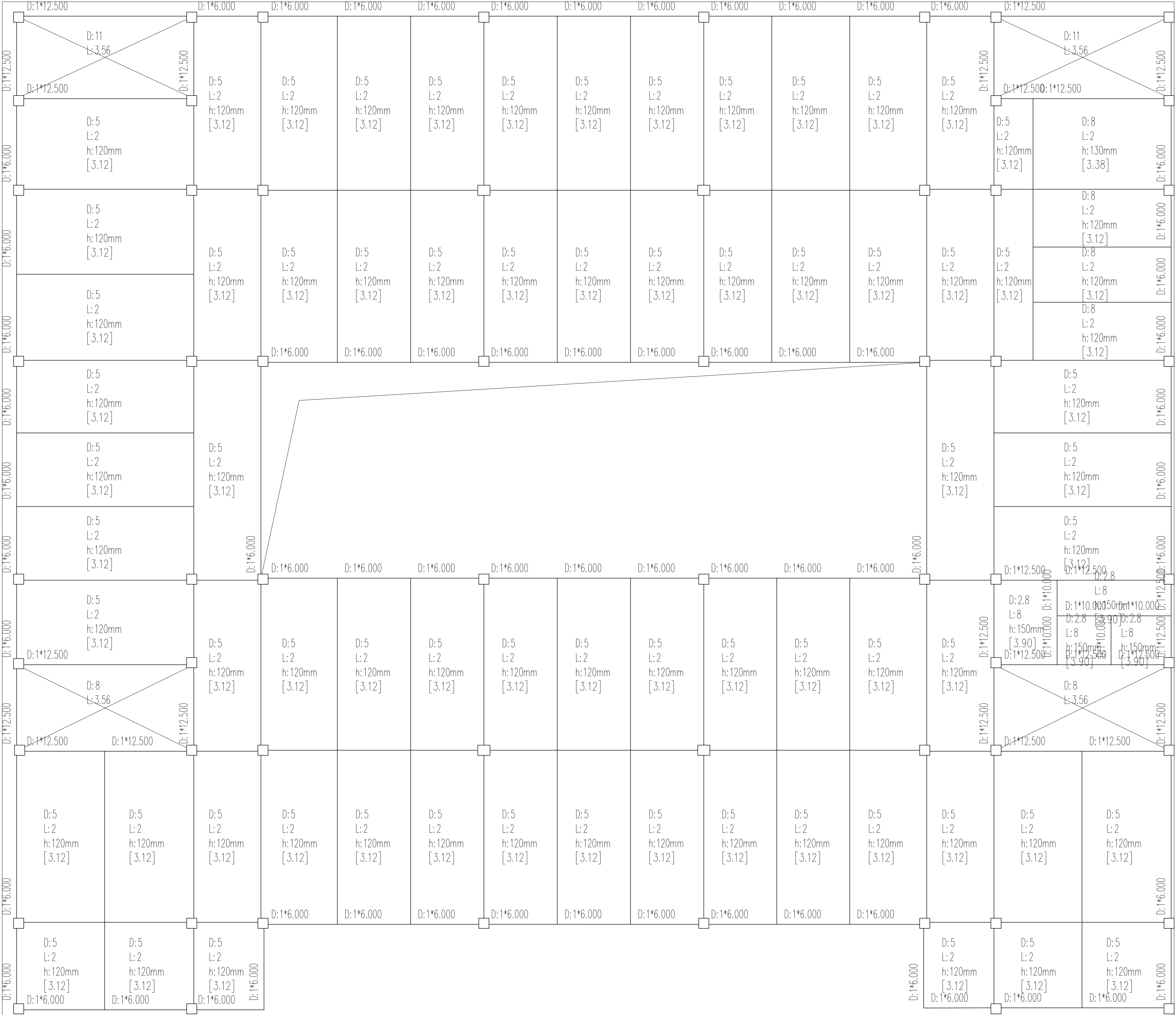
第 8 层(第 8 标准层)梁、墙、柱、节点荷载平面简图 [ 单位: kN·m ] [ D: 恒载 L: 活载 R: 人防荷载 h: 楼板厚度 [ ]中为楼板自重]
