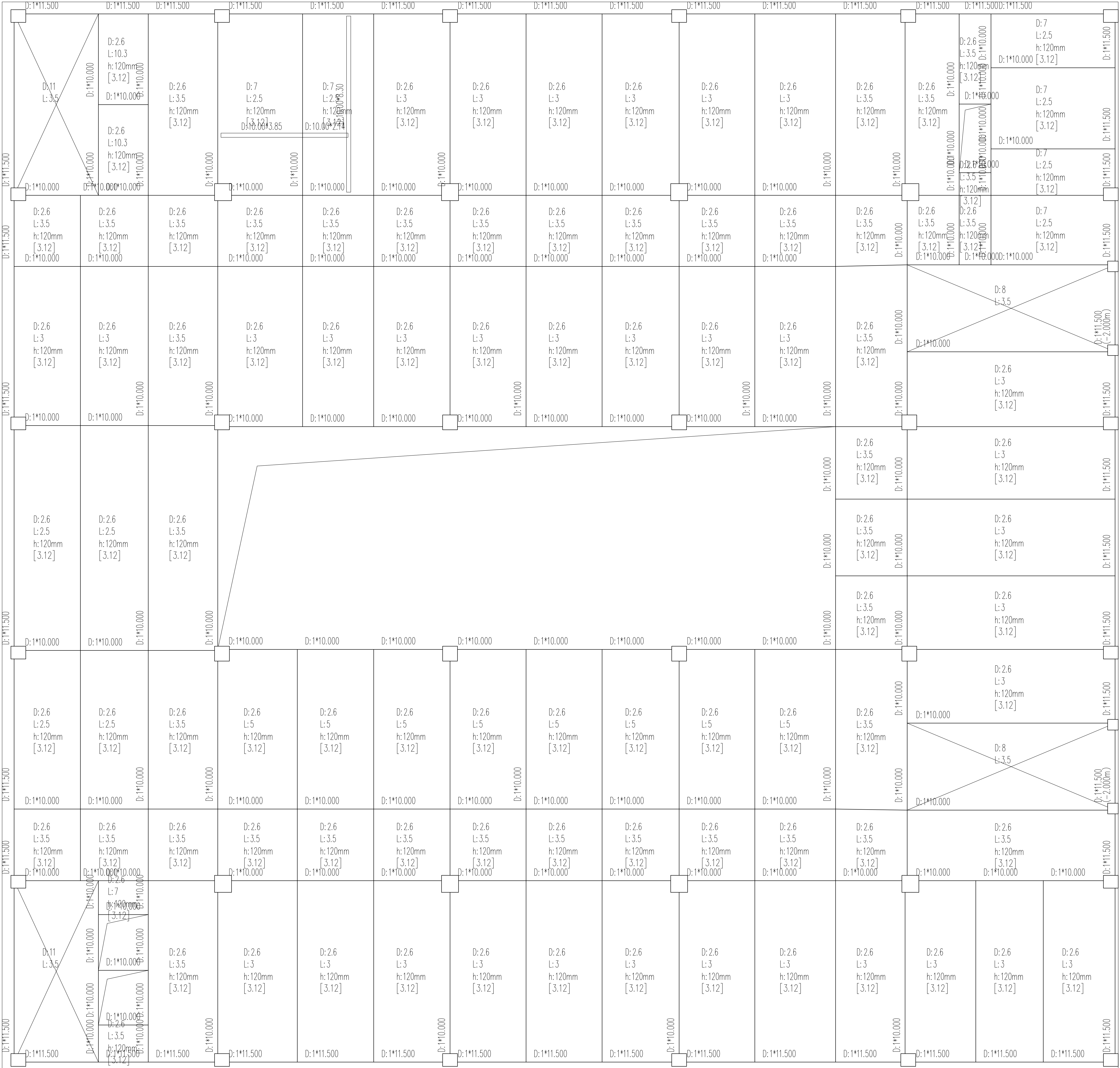
第6层(第6标准层)梁、墙、柱、节点荷载平面图 [单位:kN·m] [D:恒载 L:活载 R:人防荷载 h:楼板厚度 [ ]中为楼板自重]
