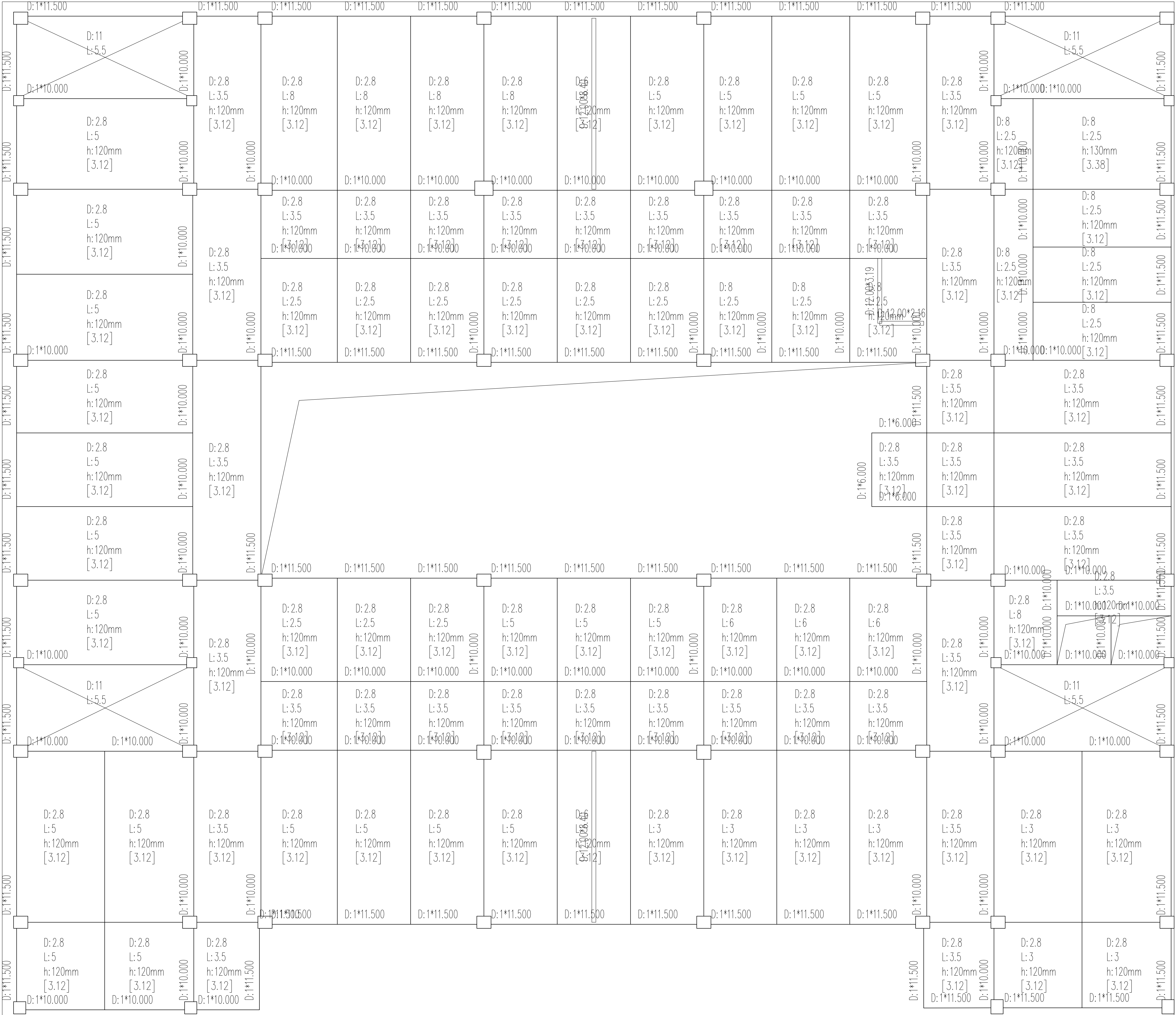
第 4 层(第 4 标准层)梁、墙、柱、节点荷载平面简图 [ 单位: kN·m ] [ D: 恒载 L: 活载 R: 人防荷载 h: 楼板厚度 [ ]中为楼板自重]
